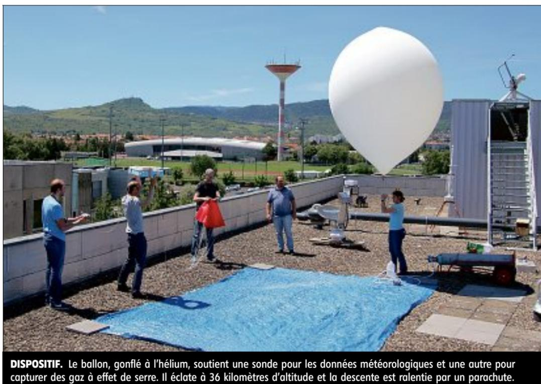
**DISPOSITIF.** Le ballon, gonflé à l'hélium, soutient une sonde pour les données météorologiques et une autre pour capturer des gaz à effet de serre. Il éclate à 36 kilomètres d'altitude et la descente est ralentie par un parachute.
